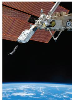
**Nanosatellites Dove.** On les voit ici en train d'être libérés dans l'espace par le système de déploiement de CubeSats de la société Nanoracks. Il s'agit de l'élément rectangulaire blanc situé sur le bras robotique du laboratoire japonais Kibo. (NASA)
